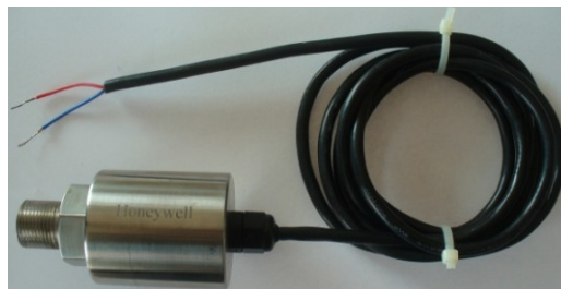
压力变送器实样图片
